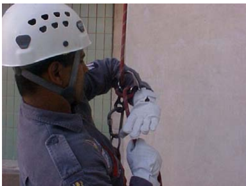
Com o chicote tesado, passe-o à mão de apoio
