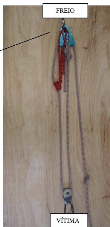
Exemplo de um sistema pré-montado de vantagem mecânica
