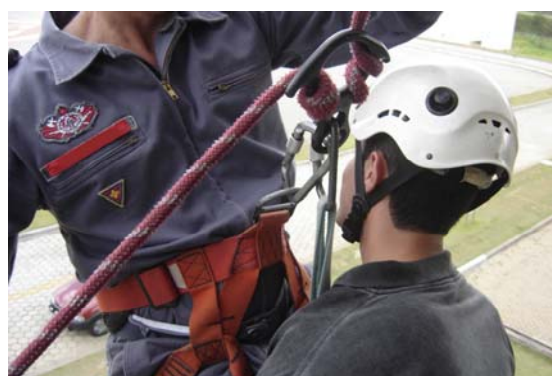
Mantenha a mão de comando afastada do freio (quando utilizar a passagem dupla pelo oito)
