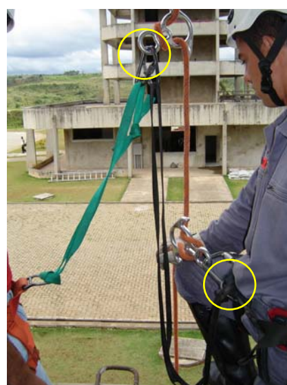
Conexão do auto-seguro do bombeiro ao freio da vítima
