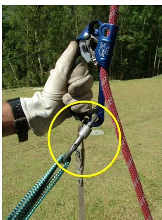
Conecte o auto-seguro e ajuste a pedaleira
