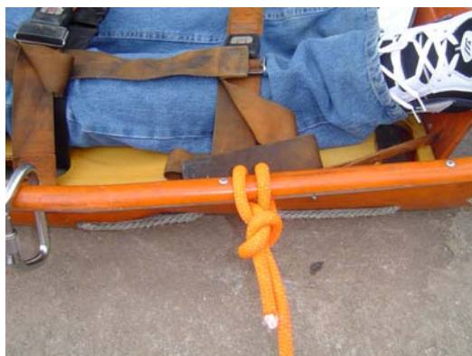
Inicie a fixação com o cabo da vida e o nó volta do fiel
