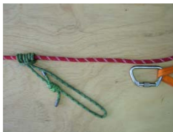
PRUSSIQUE A CORDA COM TRÊS VOLTAS
