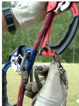
Conecte o auto-seguro e ajuste a pedaleira
