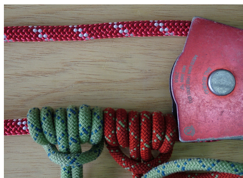
A polia de base chata permite o desliz da corda com os prussiks solecados
