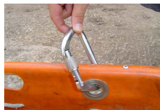
Posicione a trava dos mosquetões para o lado interno da maca
