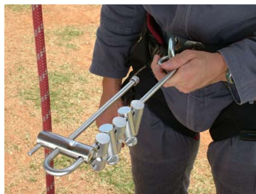
Clipe o rack à cadeira e em seguida, abra as barras para passagem da corda
