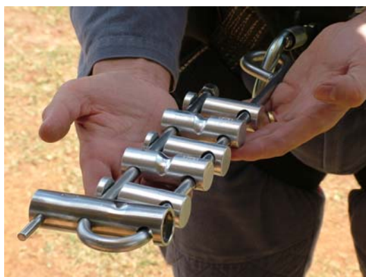
Clipe o rack à cadeira e em seguida, abra as barras para passagem da corda
