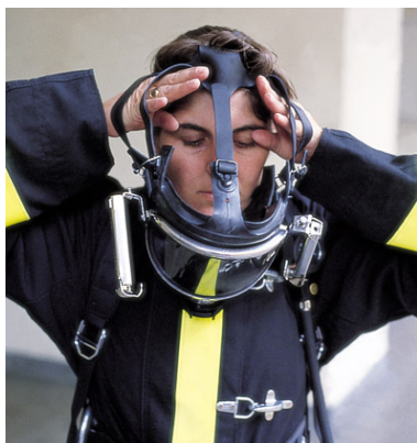
Fig. 13.6-C – Colocar a peça facial.
