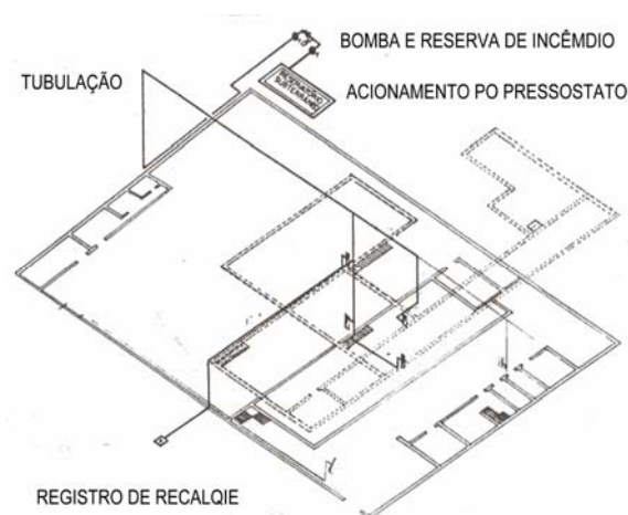
Isométrica de sistema de hidrantes (Fig. 1.63)
