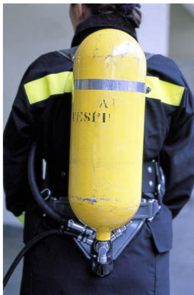
Fig. 13.3-E – Posição do cilindro de ar comprimido.
