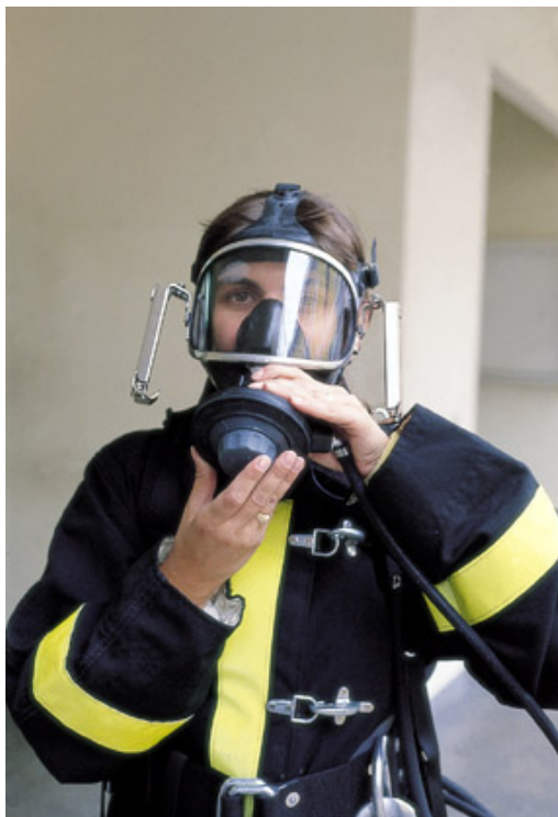
Fig. 13.6-G – Acoplar a válvula de demanda.
