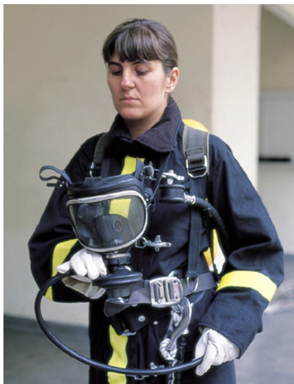
Fig. 13.3-I – Inspeção visual da peça facial e do tubo condutor.
