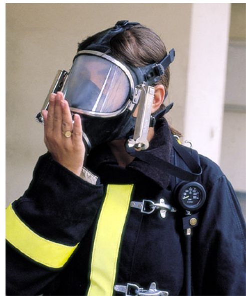
Fig. 13.6-F – Verificar a vedação da peça facial inspirando e tampando a entrada de ar. “Não pode ocorrer entrada de ar”.
