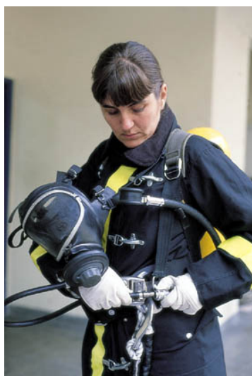
Fig. 13.3-J – acoplamento do tubo condutor à saída de ar do redutor de pressão, através da conexão.
