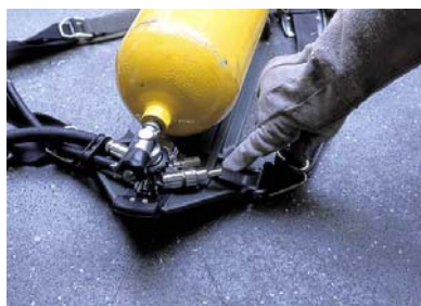
Fig 13.3-G – alarme sonoro que anuncia o término do suprimento de ar respirável.
