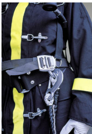
Fig. 13.3-D – Detalhe do fechamento correto do cinto de suporte do aparelho.
